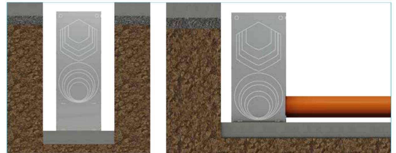
La parte inferior de la arqueta también se puede rellenar de hormigón para una mejor consolidación inicial, teniendo en cuenta de no sobrepasar la marca inferior de la tubería.
