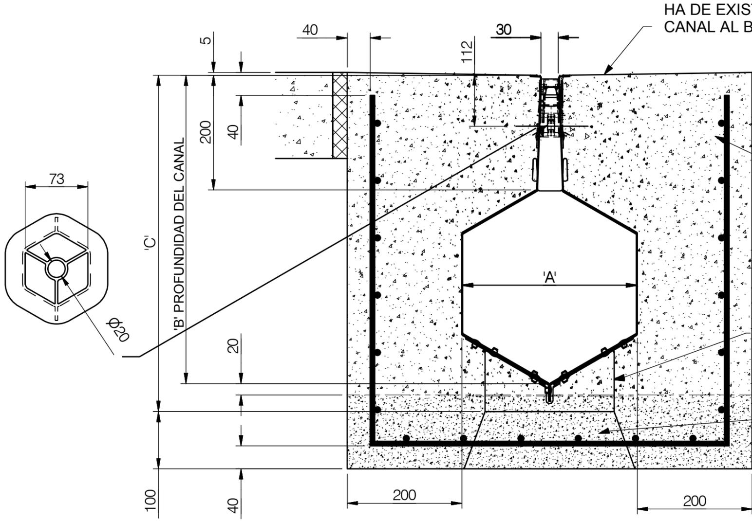
HA DE EXISTIR UN DIFERENCIAL DE COTA DE 5 mm DEL CENTRO DEL CANAL AL BORDE DEL DADO HORMIGÓN
